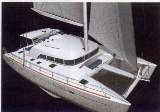
Lagoon 440: senkrechte Scheiben, Stummelkiele und viele Varianten für den Innenausbau
